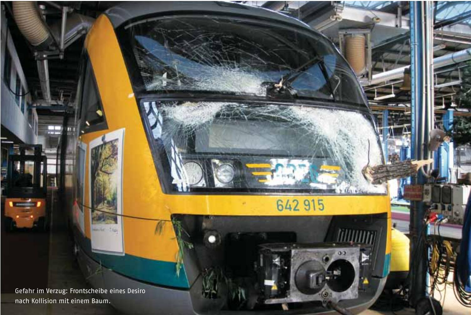
Gefahr im Verzug: Frontscheibe eines Desiro nach Kollision mit einem Baum.
